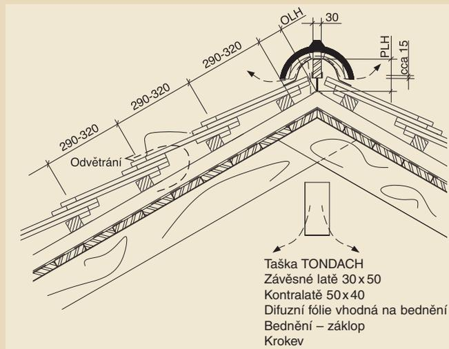
Odstup latě od hřebene (OLH) je variabilní a řídí se podle příslušného sklonu střechy dle detailního nákresu hřebene (PLH – převýšení latě nad hřebenem resp. kontralatěmi).
