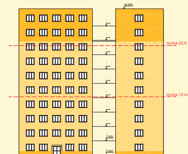
Zateplení při rekonstrukci s použitím TWINNERU (výška objektu nad 12 m)
